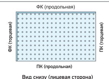
Плиты САУНДЛАЙН-Акустика 2ФК/2ПК имеют две фальцевые (торцевую и продольную) ФК и две прямые (торцевую и продольную) ПК кромки. Это позволяет выполнять точнуюстыковку плит с автоматическим образованием зазора. Монтаж рекомендуется производить бригадой из 3-х человек.
